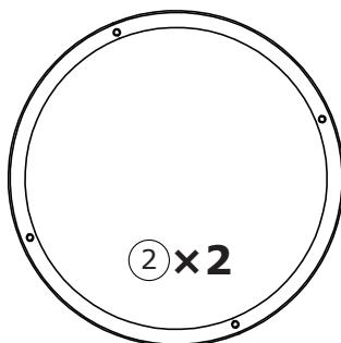
$\varnothing 400 \times 20\text{mm}$
